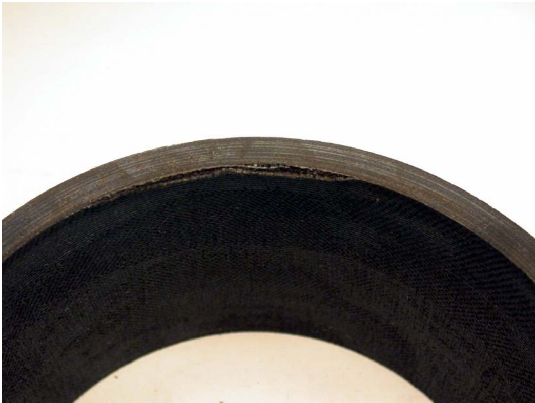
圖片 6: 在軸承內部邊緣出現細微的布層分裂
