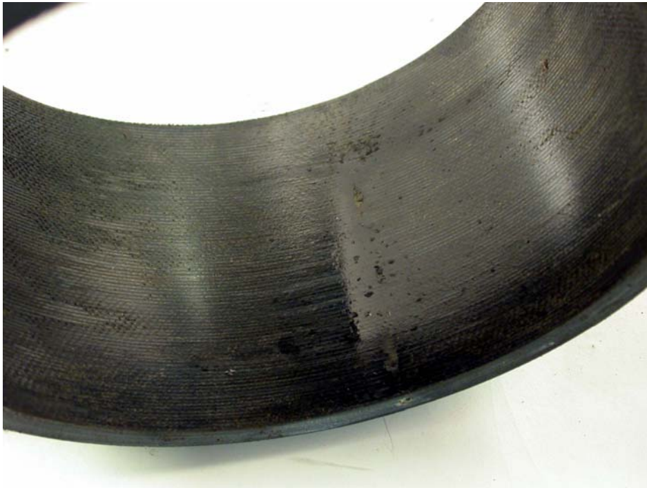
圖片 4: 乾測試完畢後之自潤軸承接觸面呈現高度拋光 (外緣小孔為測溫器安裝孔)
