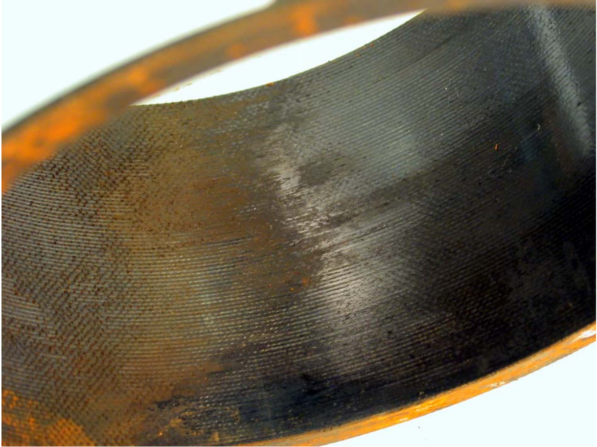
圖片 15: 濕測試完畢後之自潤軸承非負載接觸面 注意其中之負載接觸面與非負載接觸面之不同處
