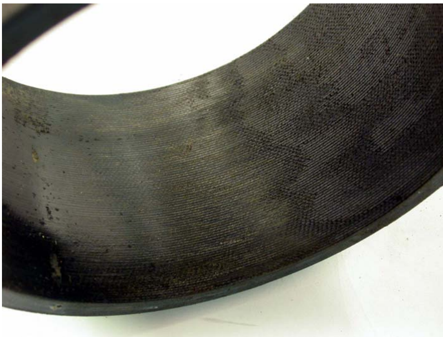
圖片 5: 乾測試完畢後之自潤軸承無負載之接觸面 可明顯看出布層結構
