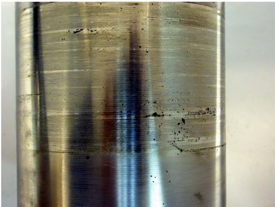
圖片 3: 測試軸套中央接觸面附著一層來自自潤軸承的潤滑劑薄膜和極為細小的磨屑
