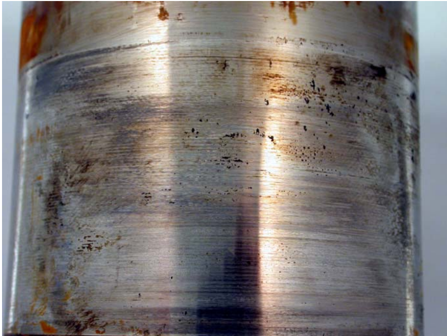
圖片 13: 濕測試軸套與乾測試一樣中央接觸面附著一層光亮薄膜以及細小的磨屑
