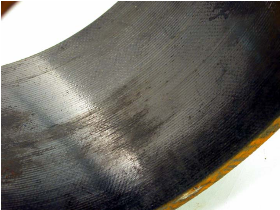
圖片 14: 濕測試完畢之自潤軸承接觸面呈現出高度拋光
